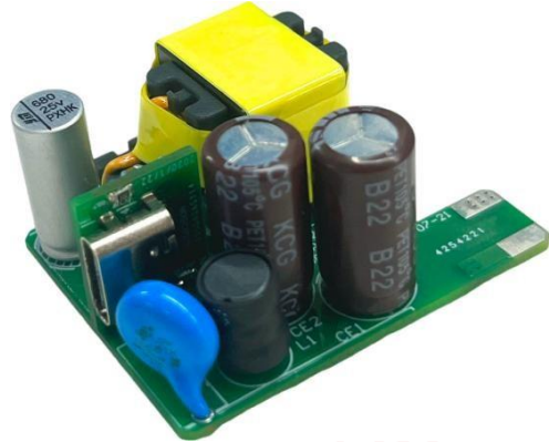
样机尺寸 (mm): 长 x 宽 x 高=38.5mm x 30.1mm x 19.8mm
